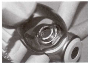
タンク内にオイルミストをはじめ、異物が混入しているときにはファーストステージにフィルター部にそれが付着したり、錆びが見られることも。時々チェックを
