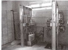
圧縮された空気を油水分離器に通してドレンを取り除き、フィルターで汚れを除去した後、タンクに充填していく (丸金ストアで撮影)
